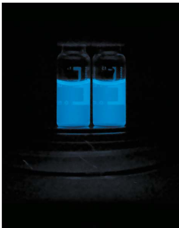
Люминесценция синтетического люциферина в присутствии экстракта червей F.heliota , АТФ, кислорода O 2 и ионов магния Mg 2+ .
